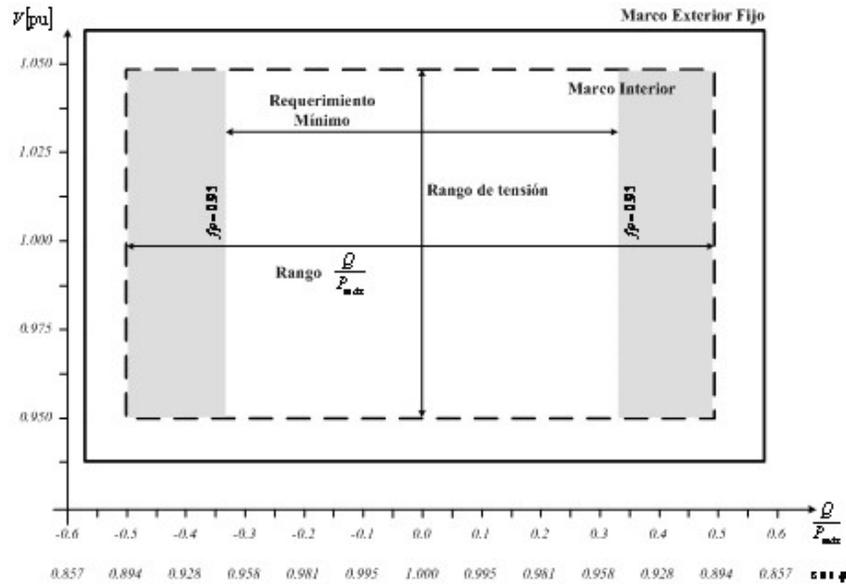
Figura 6: Diagrama V-Q/Pmáx de una Central Eléctrica.
