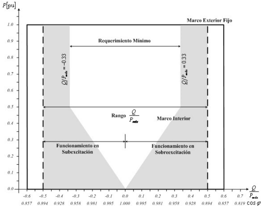
Figura 8: Diagrama P-Q/Pmáx de una Central Eléctrica.
